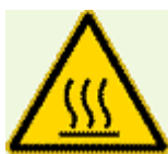
Pericolo superfici calde
