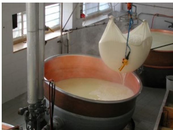
Ausilio che consente il sollevamento meccanico delle tele con la massa caseosa
