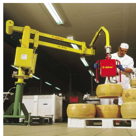
Manipolatore utilizzato per movimentare le forme di grana ( Dalmec S.p.A. )
